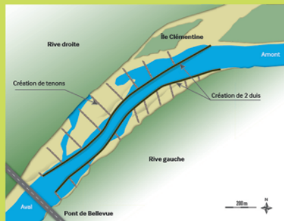
Variante A : rétrécissement du chenal, maintenu au centre, et création de tenons
